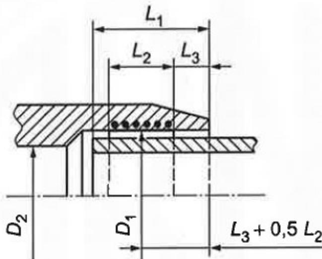
Figura 1 – Conexão de eletrofusão tipo bolsa
